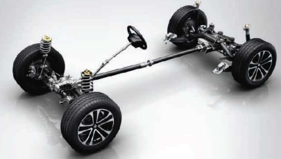
سیستم چهارچرخ محرک هوشمند iAWD - ساخت شرکت بورگ وارنر
